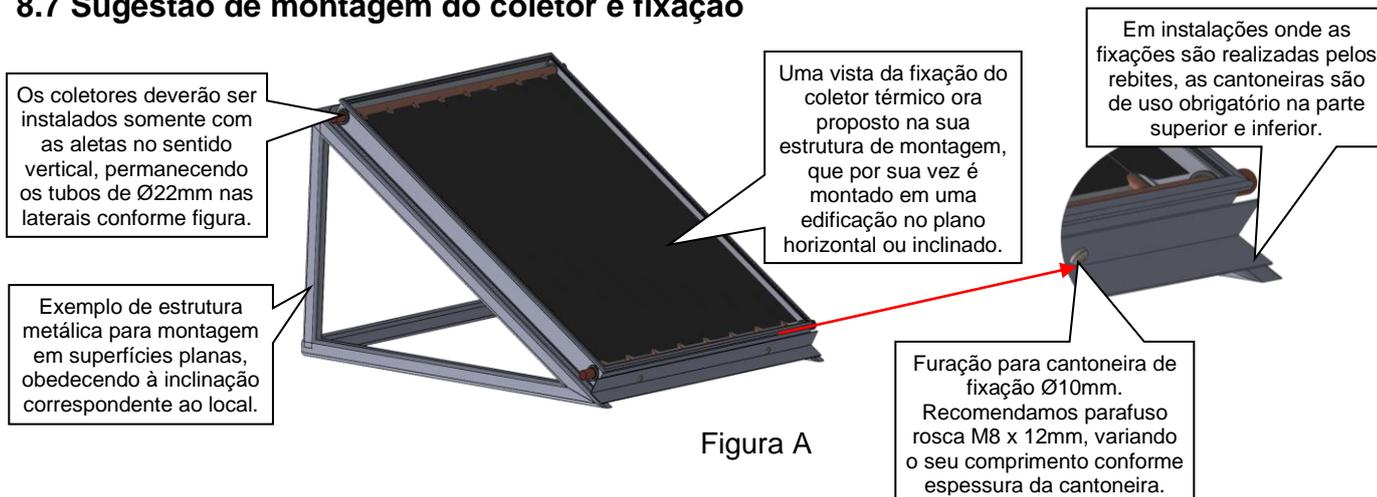
As instalações dos coletores sobre o telhado é sempre a primeira opção, pois oferecem as melhores condições de espaço, posicionamento e geralmente livre de sombras. Mas quando a inclinação do telhado for prejudicar o funcionamento do sistema, será necessária a construção de uma estrutura para corrigir a inclinação de funcionamento (como mostrado abaixo nas figuras B e C).
